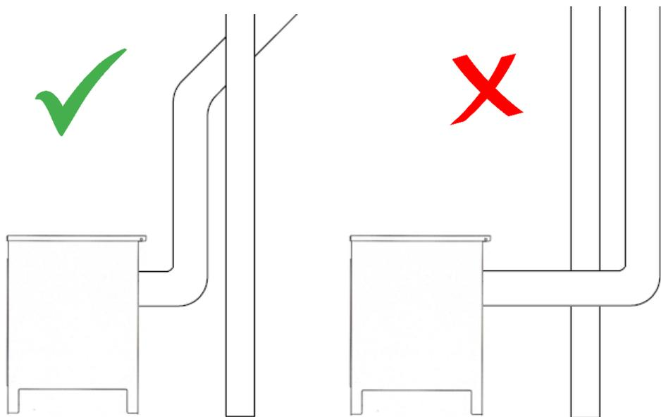
Figura 5. Instalación Correcta e Incorrecta del Aparato I
