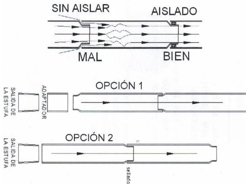
Figura 7. Instalación Tubos
