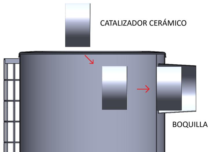
Figura 9. Instalación correcta Catalizador Cerámico
