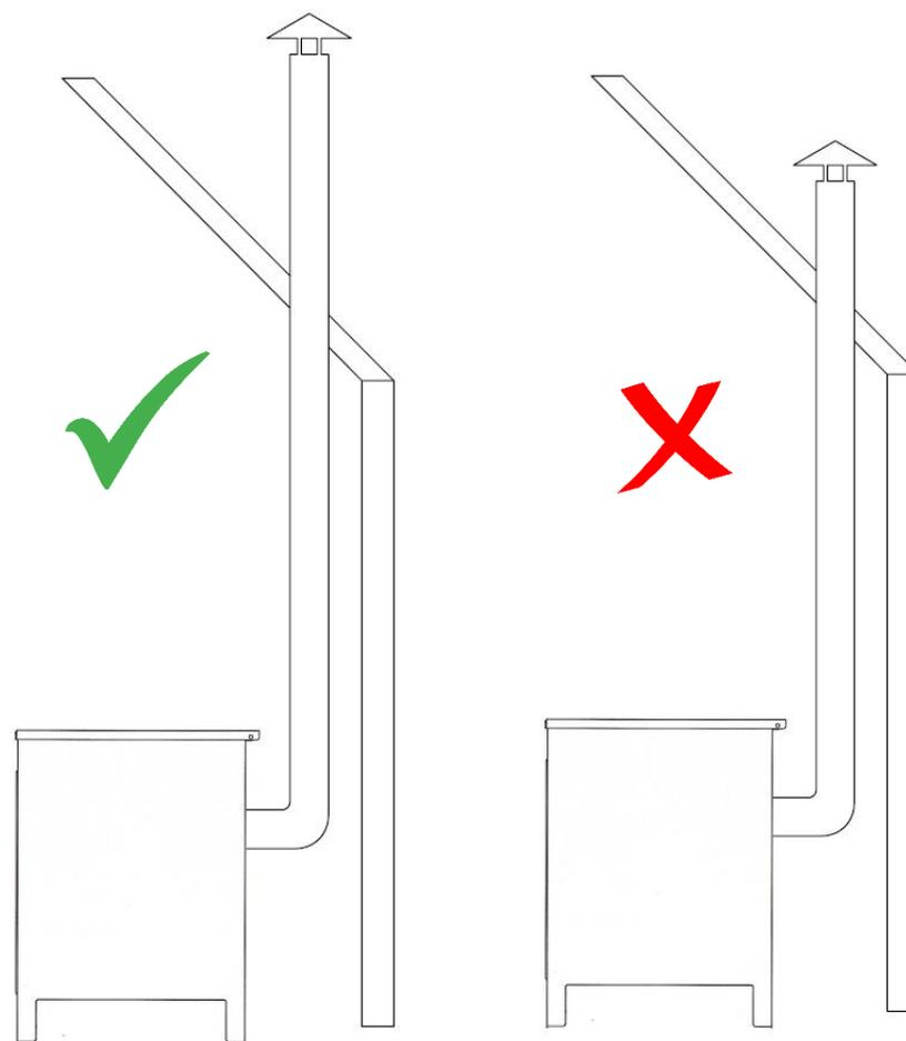
Figura 6. Instalación Correcta e Incorrecta del Aparato II
